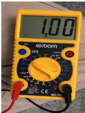
Figura 4: Multímetro utilizado durante o experimento para análise de tensão e corrente da bateria.
