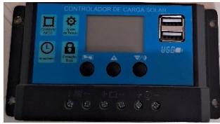
Figura 18: Controlador de carga.
