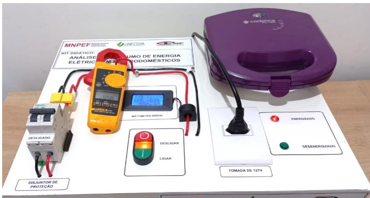
Figura 04 - Alicate amperímetro em uso no kit didático: análise de consumo de energia elétrica em eletrodomésticos
