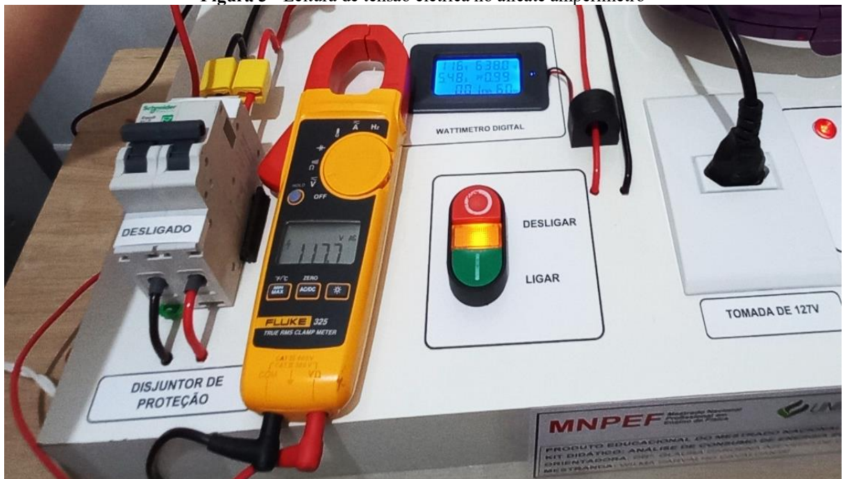
Figura 3 - Leitura de tensão elétrica no alicate amperímetro
