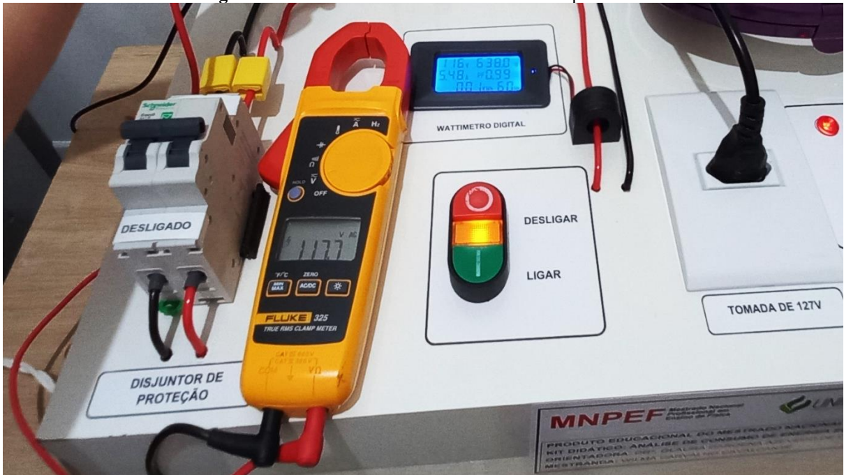
Figura 4: Leitura de tensão elétrica no alicate amperímetro
