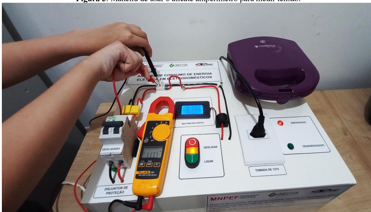
Figura 3: Maneira de usar o alicate amperímetro para medir tensão.
