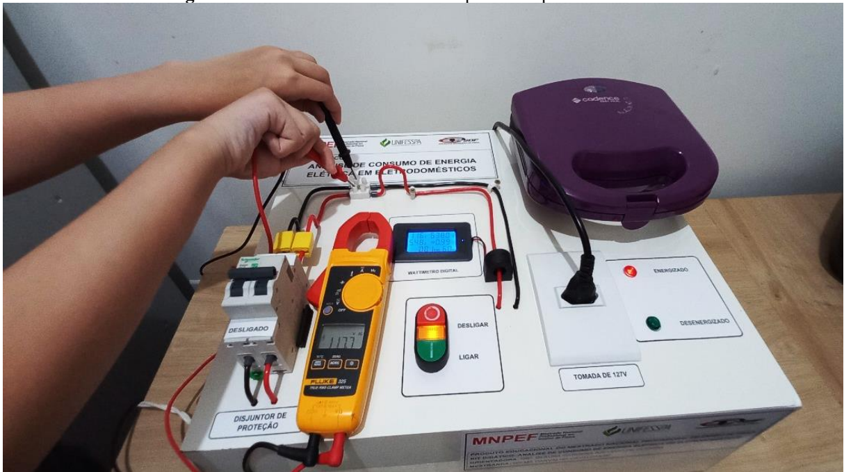
Figura 2 - Maneira de usar o alicate amperímetro para medir tensão.
