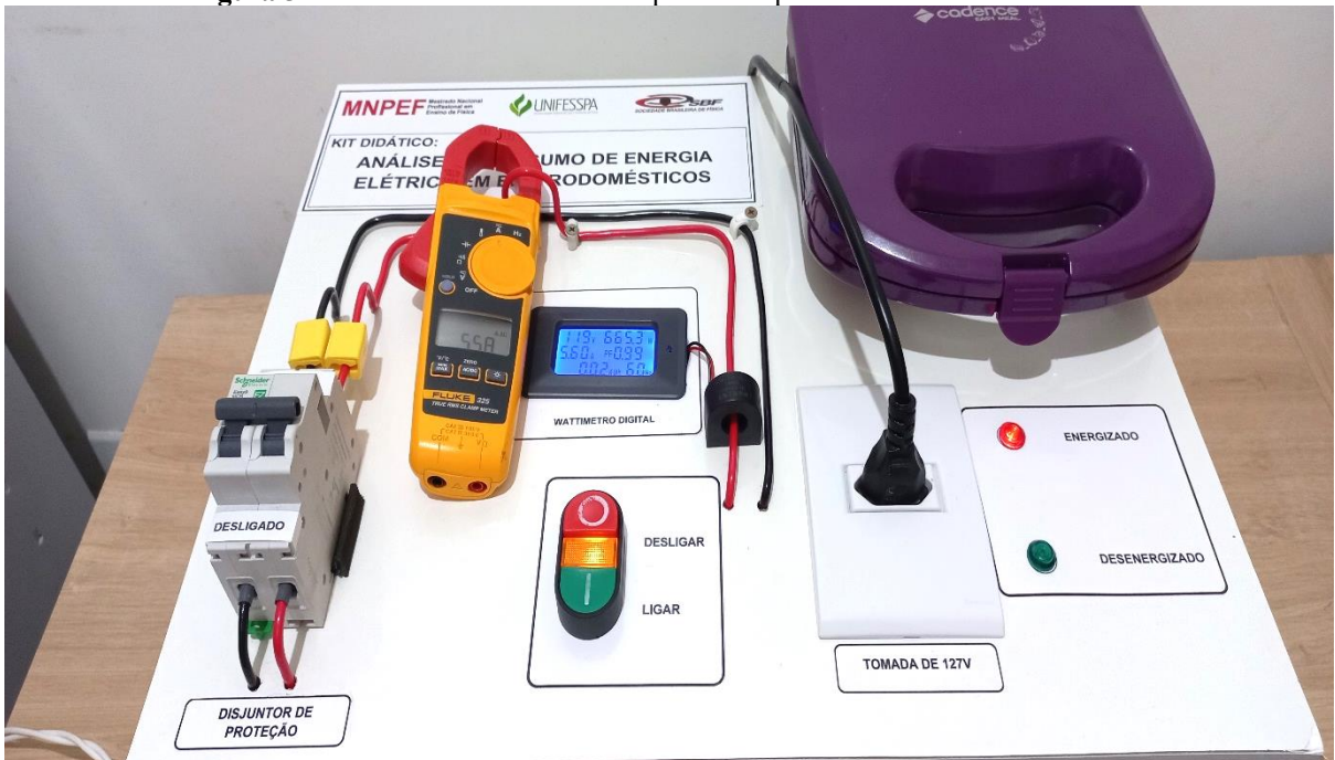
Figura 5: Maneira de usar o alicate amperímetro para leitura de corrente elétrica.
