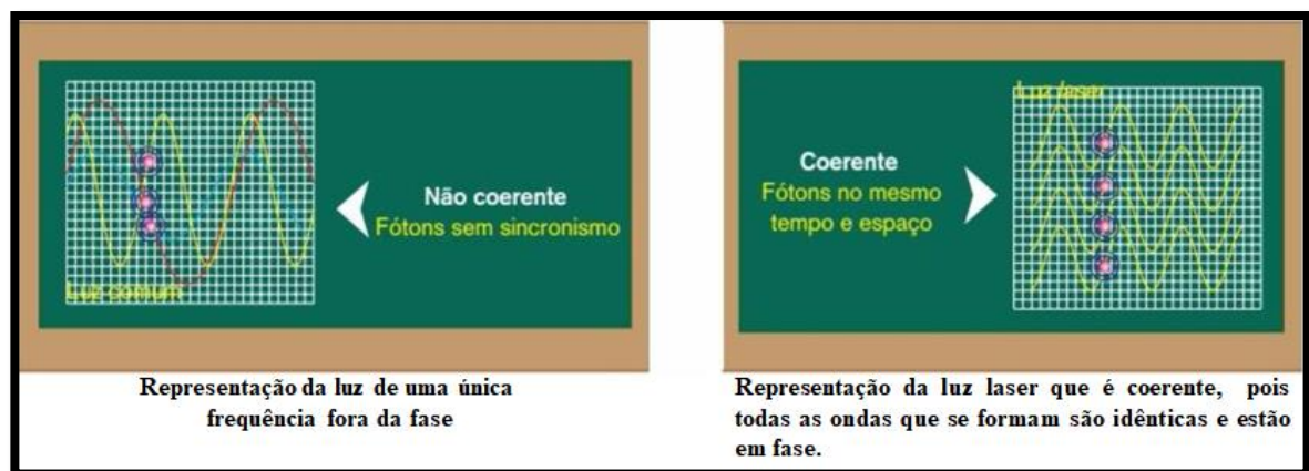
Figura 14 – Representação da frequência da luz comum e do laser
