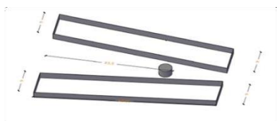
(a) Base de apoio do medidor de vazão.
