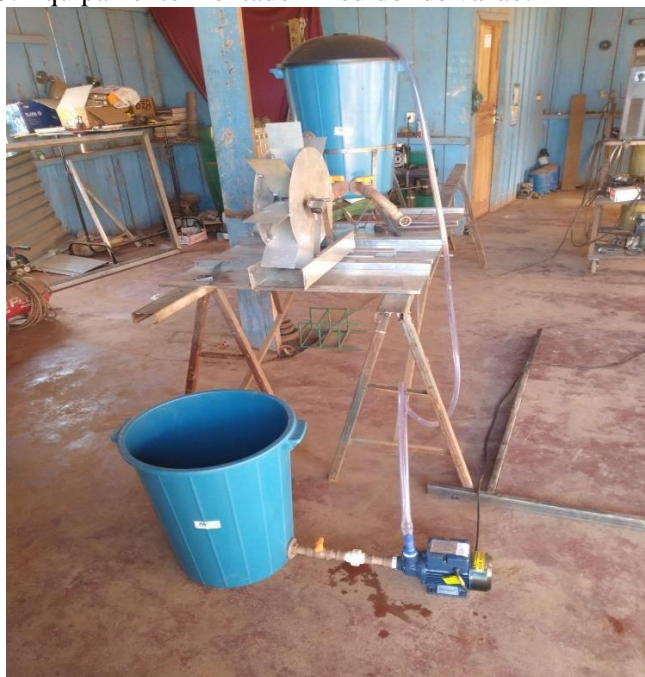
Figura 5: Equipamento montado - medidor de vazão.
