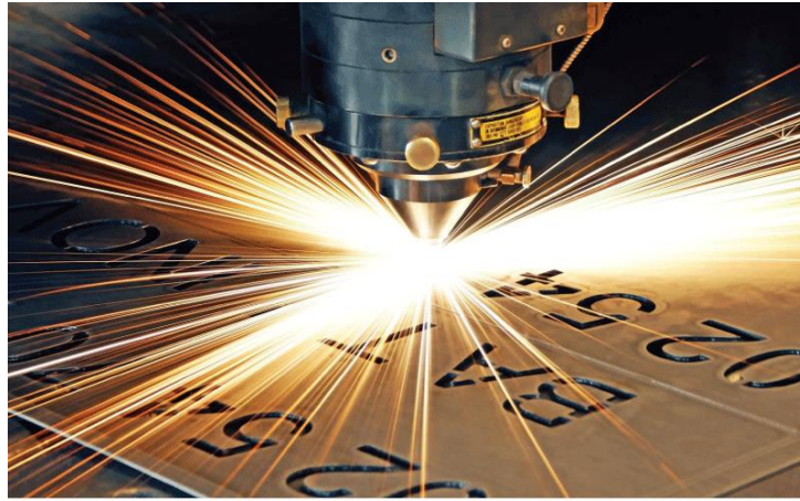
Figura 21- Laser cortando placa de metal
