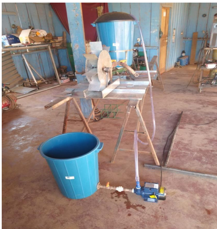
Figura 16: Equipamento montado - medidor de vazão.
