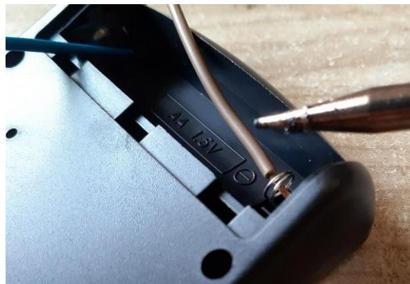
Figura 65: Soldando os fios na calculadora
