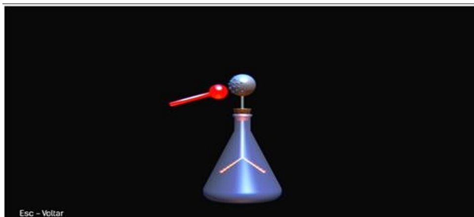
Figura 13 – Bastão metálico( Indutor) e do eletroscópio com as folhas metálicas (induzidas)
