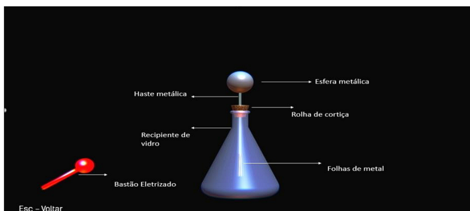
Figura 21 – Animação Eletroscópio de Folhas- Peças que constituem o aparelho
