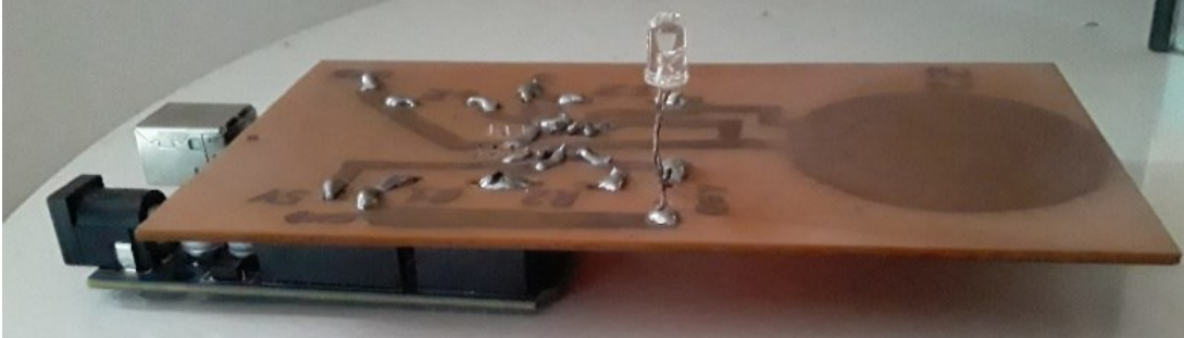
Figura 25 - Vista lateral do sensor de presença capacitivo acoplado ao arduino
