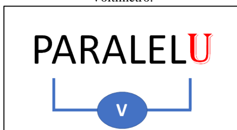
Figura 71 - Esquema explicativo para introdução no circuito em paralelo para a medição usando o Voltímetro.
