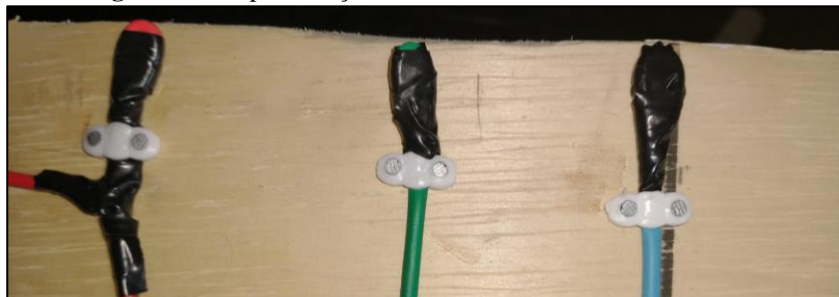
Figura 35 - Representação das extremidades fixadas dos cabos.
