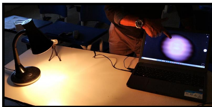
Figura 12 – Montagem: Câmera, lâmpada e notebook
