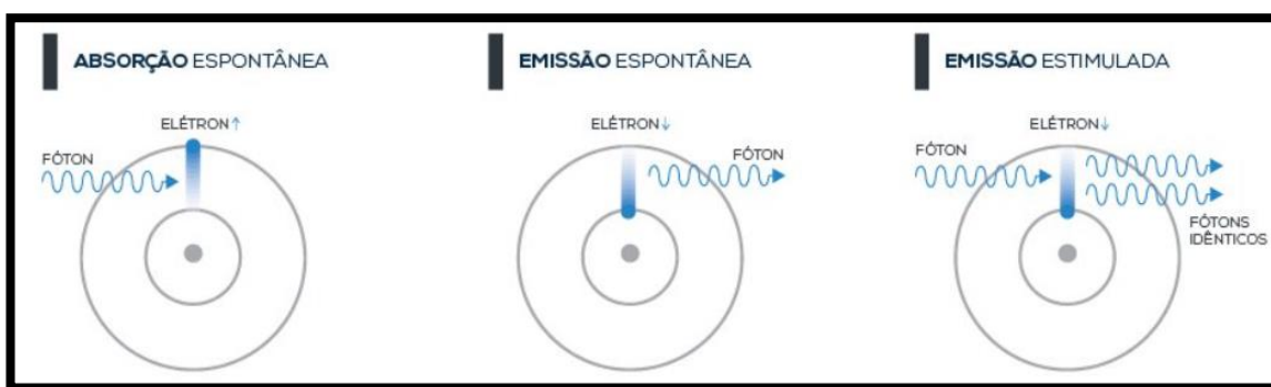
Figura 15 – Etapas do processo de emissão de raio laser
