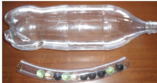
Figura 11 - Material e montagem de experimento com garrafa PET, mangueira e bolinhas de gude.
