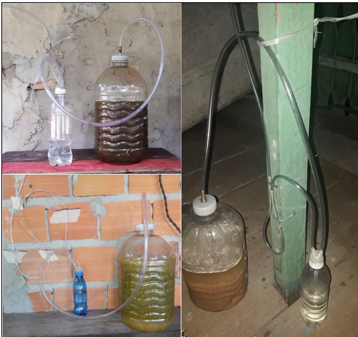
Figura 17: Biodigestores já em funcionamento
