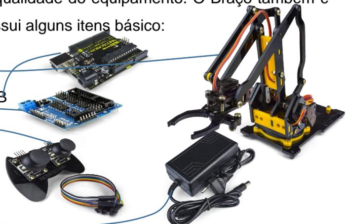
Esse Kit permite a realização de alguns experimentos: transporte de objetos para posições diferentes, carregamento de massas variadas para cálculo de potência dos motores, cálculo do trabalho da força peso, entre outros. Como nesse roteiro, o objetivo é relacionar Energia e tempo, será utilizado o cálculo da Potência do Braço robótico.
