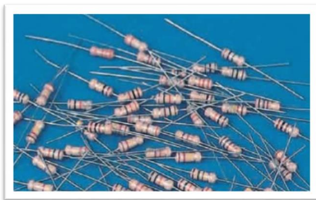
Figura 2 - Resistores variados. As faixas coloridas indicam o valor da resistência através de um código.
