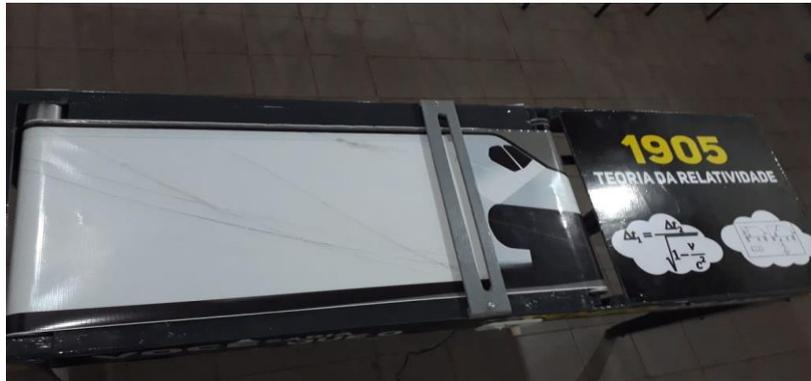
**Figura 9:** Vista de cima do dispositivo, mostrando a parte que deve ser rabiscada na tela e que deve mostrar a trajetória do pulso luminoso na experiência. **Fonte:** Autor, 2018.
