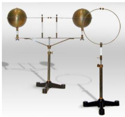
Figura 2: Esquema experimental utilizado por Hertz para produzir ondas eletromagnéticas.
