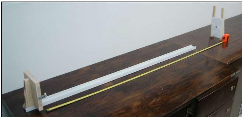
**Figura 15:** Medida do raio de curvatura " $R$ ".
