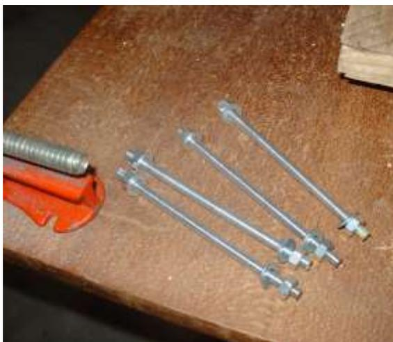
**Figura 05:** Parafusos para fixaçã do suporte do tubo
