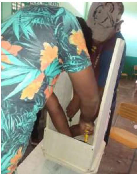
**Figura 51:** Construção do suporte do tubo.
