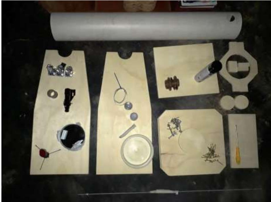
Conjunto de materiais a serem utilizados para a construção do telescópio. Em exceção aos componentes ópticos, todos os demais podem ser facilmente encontrados em lojas para matéria de construção.
