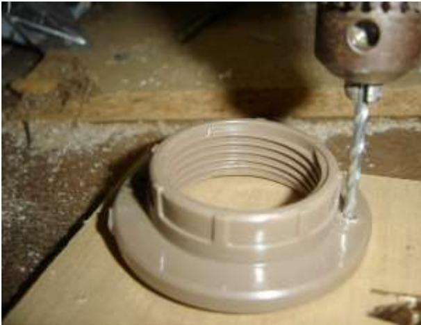
**Figura 07:** Fixação da flange no tubo
