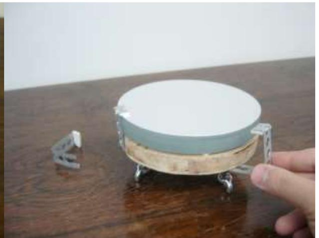
**Figura 10:** Fixação do espelho na base
