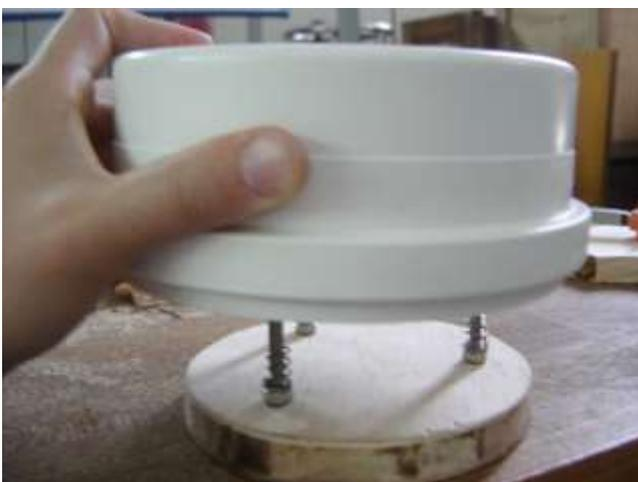
**Figura 11:** Encaixe do espelho secundário no tubo óptico
