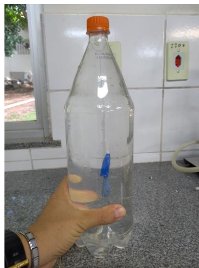
Figura 05: Apertando a garrafa a tampa desce Figura 06: Solando a garrafa a tampa sobe
