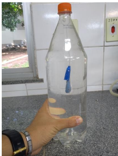
Figura 05: Apertando a garrafa a tampa desce Figura 06: Solando a garrafa a tampa sobe
