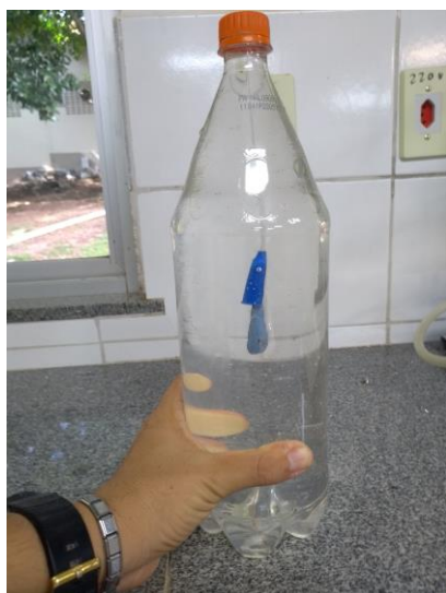
Figura 05: Apertando a garrafa a tampa desce
