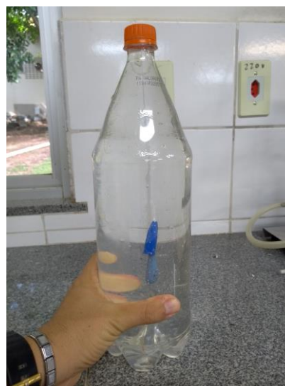
Figura 06: Solando a garrafa a tampa sobe
