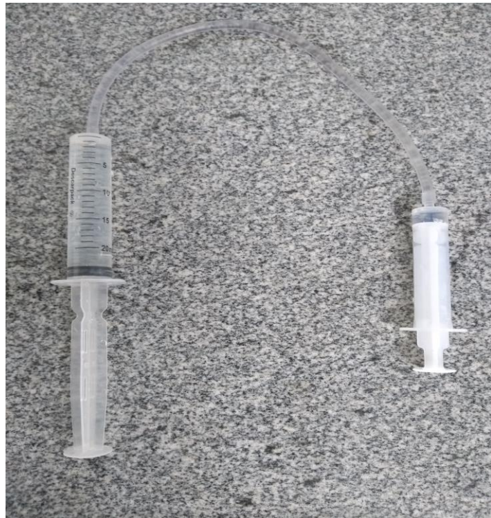
Figura 4.8: Princípio de Pascal com seringas.
